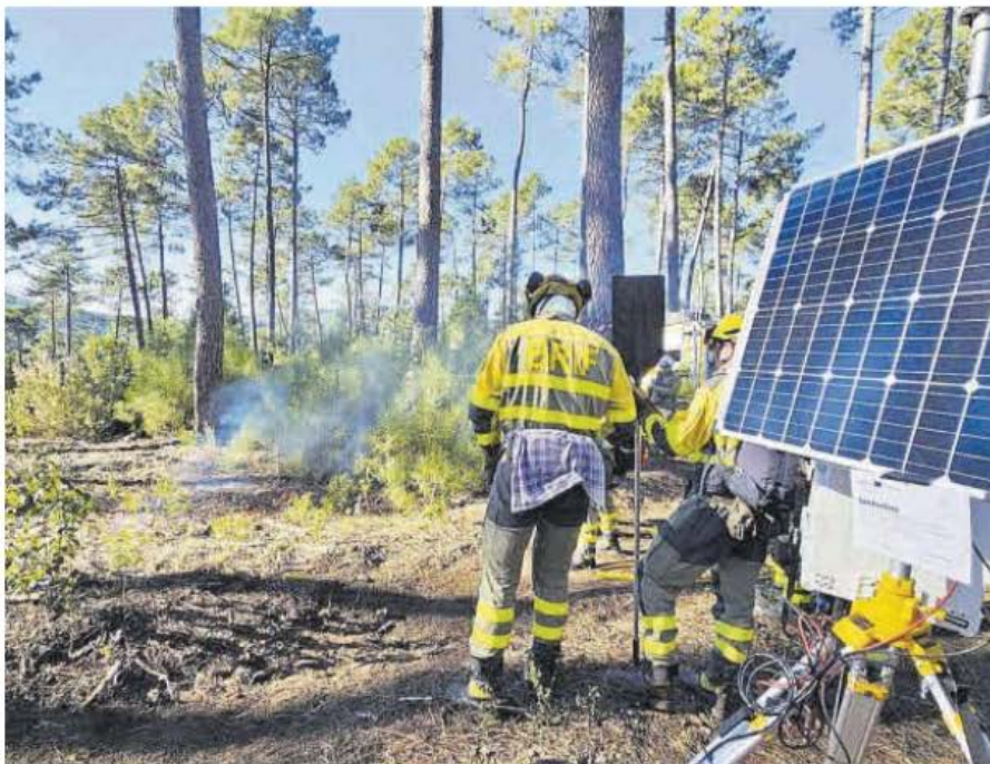
Pruebas de los sensores para la detección de incendios.
